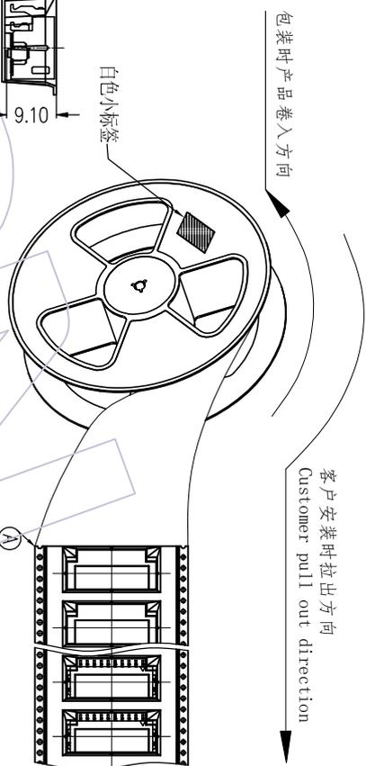
**No.1:** 产品包装前, 注意载带要留空160mm以上, 将产品放入载带凹槽后, 用盖带封装, 注意: 盖带与承载带的拉力30g~120g
